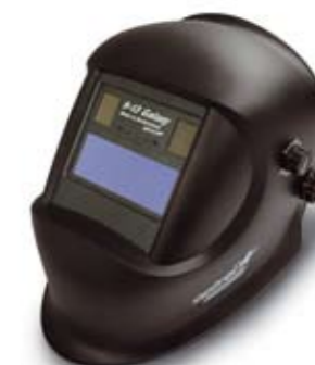
Art. 1004040 Automātiska metinātāju aizsargmaska optrel® Galaxy ar tonēšanu DIN 4/9-13. Ieslēgšanas laiks 0.5 ms pie istabas temperatūras, 0.2 ms pie 55°C, izslēgšanas laiks 0.2-0.3 s. Tonēšanas pakāpes regulators maskas ārpusē. Saules baterijas.
