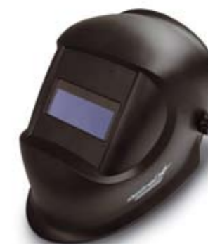
Art. 1004035 Automātiska metinātāju aizsargmaska optrel® Sirius Galaxy ar tonēšanu DIN 3/11. Ieslēgšanas laiks 0.7 ms pie istabas temperatūras, 0.4 ms pie 55°C, izslēgšanas laiks 0.2-0.3 s.
