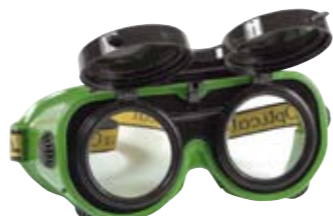
Art. 10280 Metinātāju aizsargbrilles. Lēcas no caurspīdīga plikarbonāta, paceļamās lēcas no tumši zaļa stikla, tonis 5. Netieša ventilācija. Marķējums: lēcas 1S, paceļamās lēcas 5_S1, ietvars F3.4.
